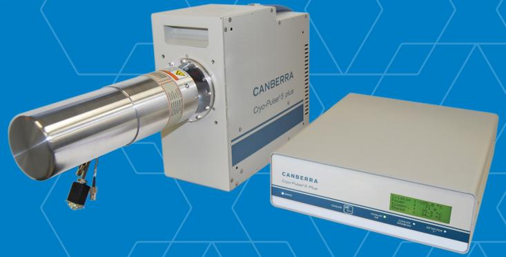
Le Cryo-Pulse 5 Plus est un cryostat à alimentation électrique pour l'utilisation avec des détecteurs HPGe. Il est doté d'un refroidisseur à tube pulsé, une technologie très fiable à l'origine utilisée dans des applications militaires et spatiales et qui a démontré sa plus-value pour l'application avec des détecteurs germanium dans le cryostat original Cryo-Pulse 5.
